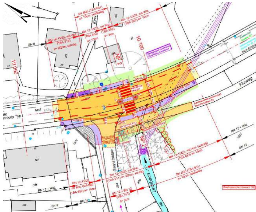
Abbildung 13: Ausschnitt Bauprojekt Situationsplan Strassenbau, Eichenberger AG
